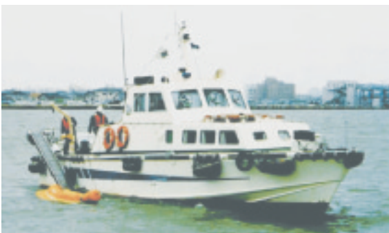
右舷後部に装着した小型油回収機「アブラアゲ」
