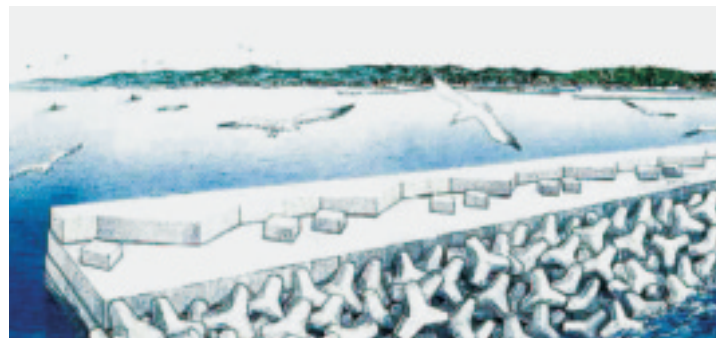
波の力を受ける時間に差をつけ経済的な断面とした 「後部パラペット防波堤」
