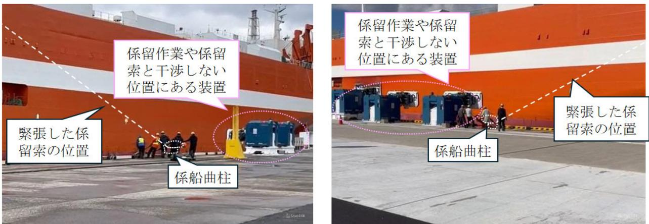
図 2-4 係留索を用いた係留作業と装置の位置関係（左：船尾側，右：船首側）
