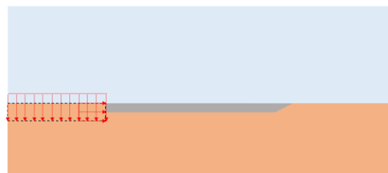
step4 タイ取付点の反力解放
