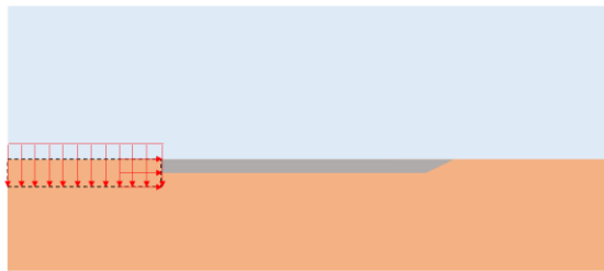
step3 タイ取付点の反力解放
