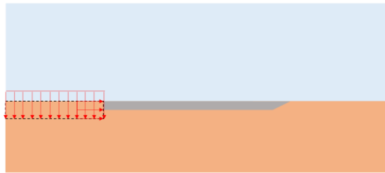
step4 掘削による応力解放
