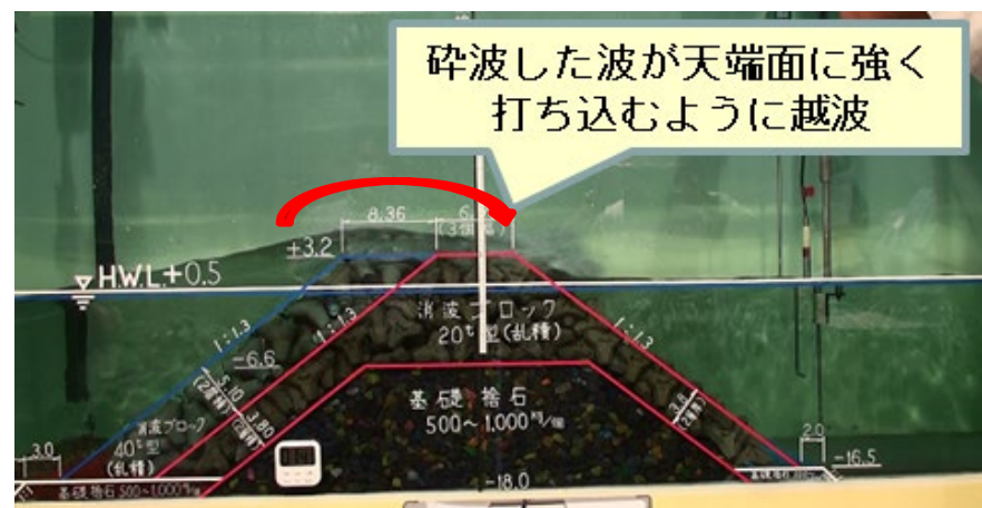
港外側腹付断面での越波状況
