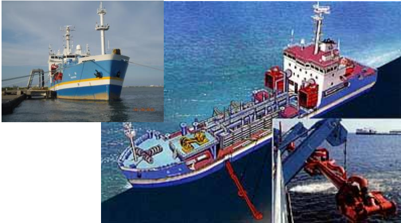
ドラグサクショ浚渫船 (新潟港湾空港整備事務所HPより)
