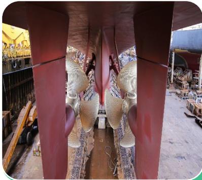
近接2軸推進システムとバブル付リアクシオン型舵を組み合わせた省エネ推進システム
