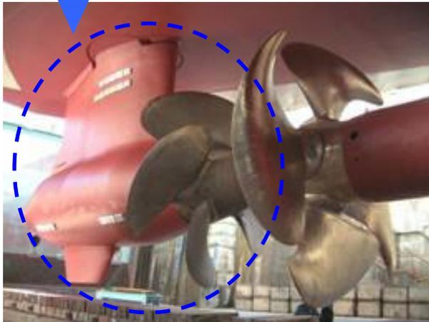
青い部分が電気モーターとプロペラを一体に組み込んだポッド推進装置。エンジンで推進するプロペラと、逆に回転させるシステムを採用。
